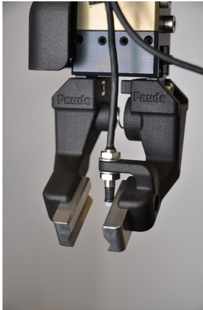
■ Greiferbacken aus Kunststoff mit gehärteten Metalleinsätzen
