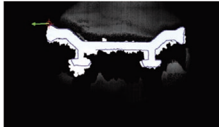
Schlechte Qualität, Schnittkanten sind unsauber, z. B. durch Grate, dennoch präzise Lageerkennung und Identifikation
