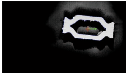
Lageerkennung der Profilstirnfläche – gute Qualität, bzw. saubere Schnittkante
