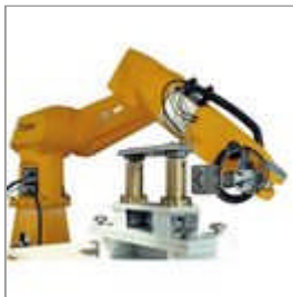
Bild 1: Ein Sechs-Achs-Knickarmroboter mit Wechselgreifersystem sorgt im Be- und Entladesystem für die nötige Flexibilität. Bild: Faude
