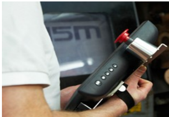
■ Einfache Bedienung und Programmierung über das 12" Touchbedienfeld
