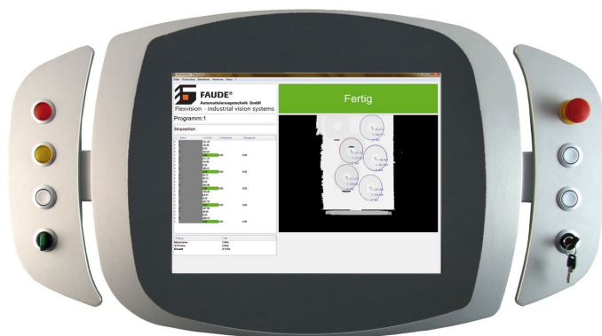
■ Touchscreen Panel-PC mit Schaltelementen
